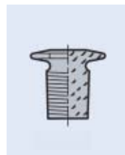
Bouchons à tête plate, bruns, à rodage normalisé, octogonaux, DIN 12 252
