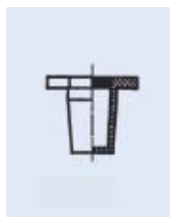
Kunststoff-Stopfen aus Polyethylen 2 DIN 12 254
